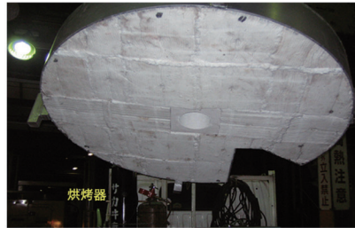
硅钢连退及不锈钢连退加热炉顶
